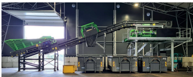
Maskin med Eddy Current teknologi for utsortering av ikke-magnetiske metaller.
